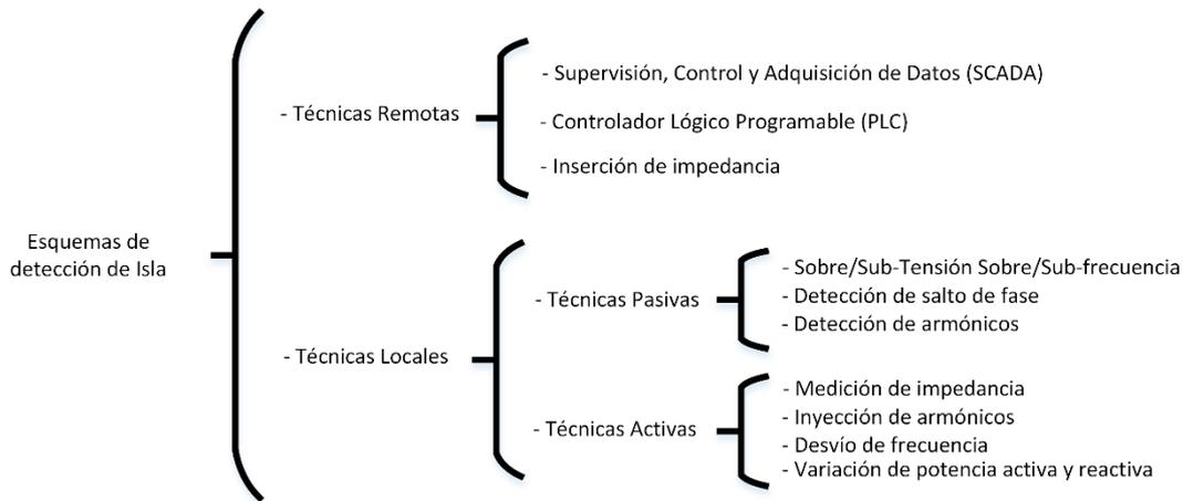
Figura 1.2.- Clasificación de los esquemas de detección de Isla
