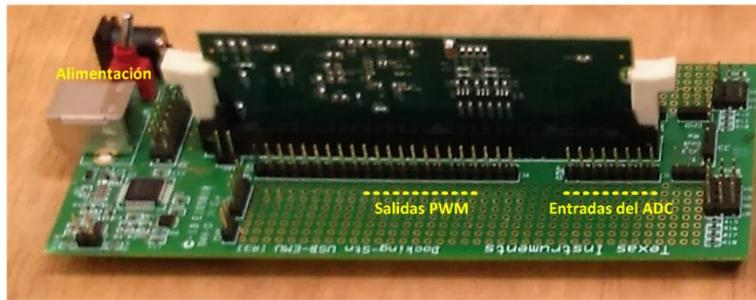
Figura 4.31- DSP con microcontrolador TMS320F28335 de Texas Instruments
